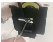
4. Alinhe a ficha da câmara com a placa de montagem.
