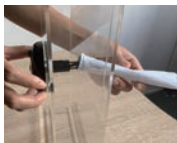
2. Coloque el cable a través de la puerta, de afuera hacia adentro. [Nota- si la puerta es gruesa, envuelva el cable en papel evite romperlo].
