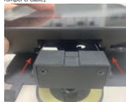
6. Alinee la ranura debajo de la máquina con la hebilla de la placa de montaje.
