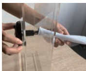
2. Coloque o cabo a atravessar a porta, de fora para dentro. [Note- se a porta for grossa, embrulhe o cabo em papel, evite parti-lo].
