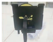
3. Na parte de dentro da porta, coloque a ficha do cabo e o parafuso através da placa de montagem. [Note- faça com cuidado para não partir o cabo].
